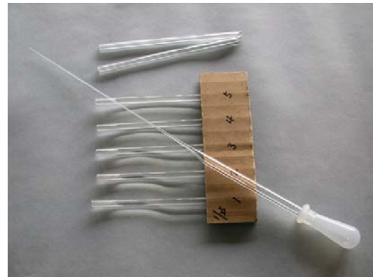
図26 成長曲線作成のための用具 一端を封じたガラス管、先端の長いマイクロピペット、ガラス管の整理と区別のために利用したダンボール片
